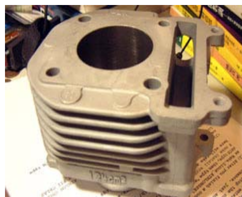
圖 7 陶瓷汽缸 外表為金屬，內部才是陶瓷
